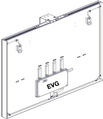
EVG für 2x LE Wenn eine EVG-Box zwei Anschlüsse hat ist es nicht möglich, dass nur eine Leuchte angeschlossen wird. Es müssen immer zwei Leuchten an dieser EVG-Box montiert sein.
